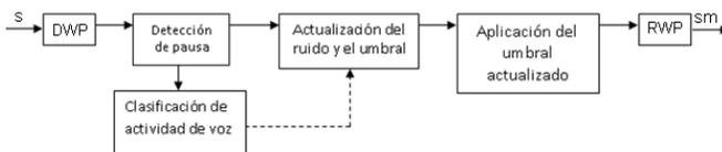
**Figura 2: Diagrama en bloques del algoritmo de reducción de ruido basado en TWP.**
