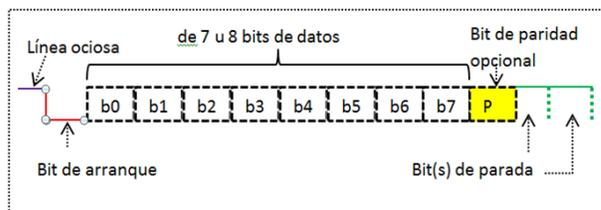
**Figura. 3: Protocolo de comunicación asincrónica de bit de arranque/bit de parada**
