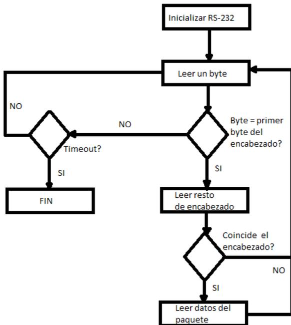
Figura. 4: Diagrama de flujo para la adquisición de datos.
